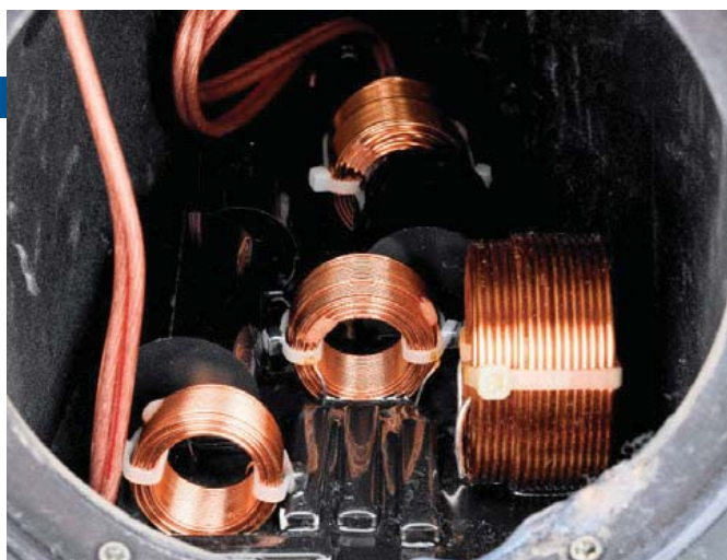
Il crossover è posizionato alla base del box. La copertura dei componenti con materiale catramoso ne rende impossibile l'analisi. Le induttanze sono tutte avvolte in aria e i condensatori sono i pregiati Clarity Cap.
