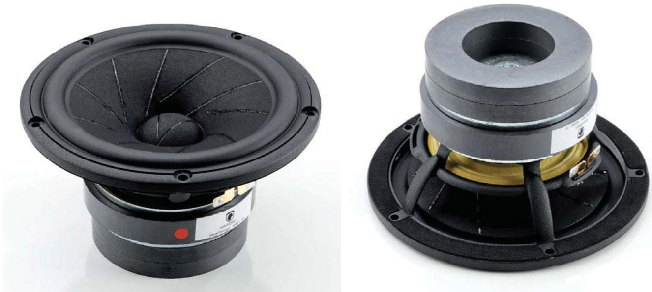
Il woofer della FM-2 è costruito dalla Scan-Speak e customizzato per la Gato Audio. Notate il disegno caratteristico della membrana rinforzata con degli "slice" di materiale più rigido ed il doppio anello di ferrite esterna.
