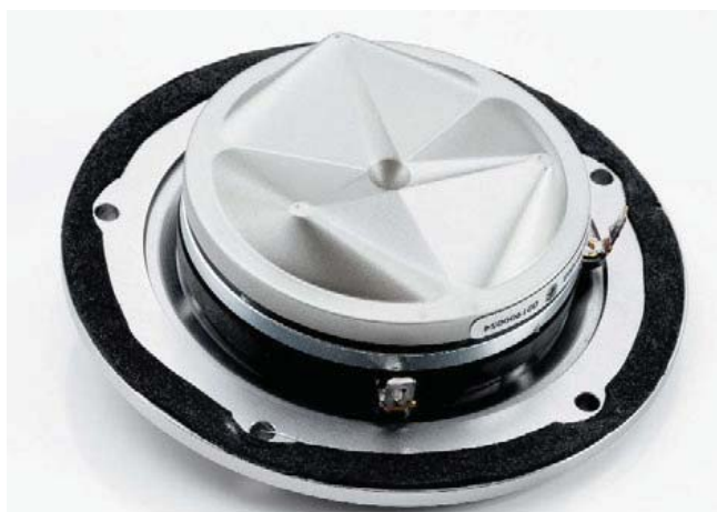
Il tweeter ha la flangia frontale in alluminio. Si tratta del Ring Radiator della Scan-Speak, anche questo realizzato per Gato Audio. Notare la camera posteriore che copre gli anelli di neodimio.
